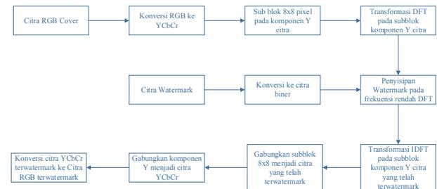
Gambar 2. Diagram Blok Proses Enkripsi
