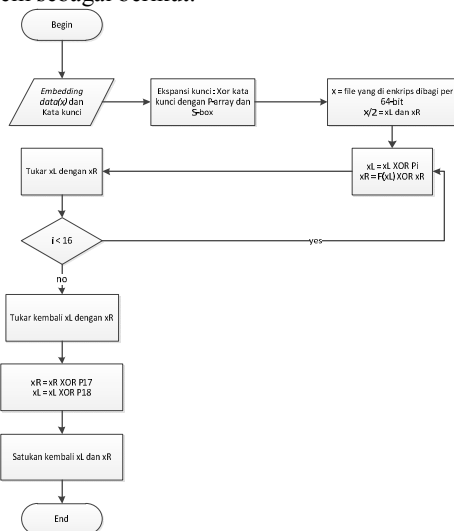
Gambar 6. Tahapan Enkripsi Input Data pada Blowfish
